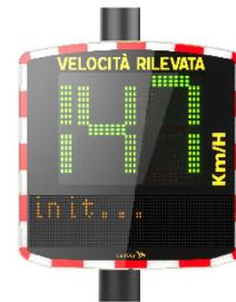
188 in verde per testare il display, poi la tensione della batteria (per esempio, 147 significa 14.7 Volts). Il display del testo mostra anche l'informazione « AVVIO ».
