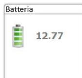
Indicazione del livello della batteria. In caso di batteria debole, l'icona cambia di colore. Una batteria completamente carica è tra i 12,8V e i 13,1V.
