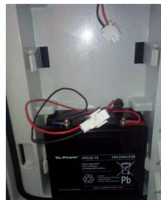
***L'autonomia del pannello dissuasore di velocità con una sola batteria (senza ricarica) va da 3 a 8 giorni. Evitare di spostare l'Evolis con all'interno le batterie, per delle ragioni di sicurezza legate al peso totale del dispositivo.***
