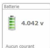
Indication du niveau de batterie. En cas de batterie faible, l'icône change de couleur. Une batterie complètement chargée se situe entre 3.9V et 4,1V
