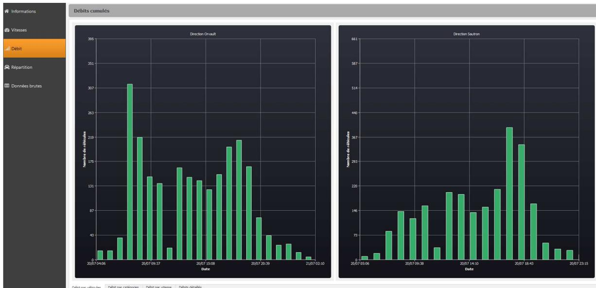
A travers ces diagrammes en barre, vous pouvez analyser les débits en fonction des dates (ou une heure souhaitée en zoomant avec la sélection de votre souris). Cela vous permettra de savoir combien de véhicule sont passés à la date recherchée. Ces diagrammes sont triés par direction.
