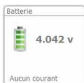
Indication du niveau de batterie. En cas de batterie faible, l'icône change de couleur. Une batterie complètement chargée se situe entre 3.9V et 4,1V
