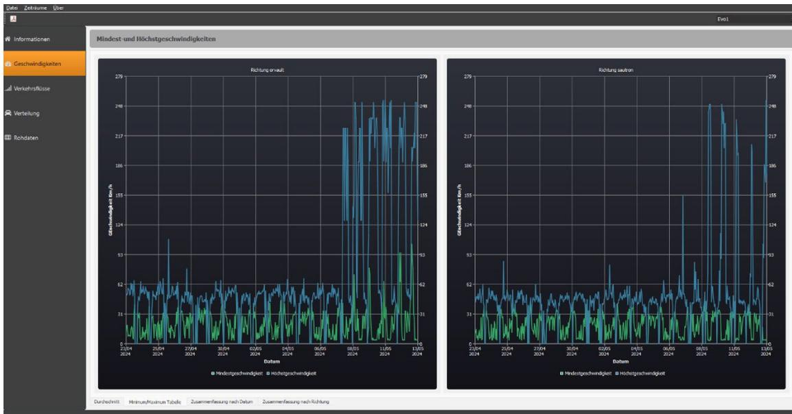
Auf der rechten Seite sehen Sie die Mindest- und Höchstgeschwindigkeiten im Verhältnis zur Durchfahrtszeit. Diesmal werden die Richtungen in zwei getrennten Diagrammen dargestellt, was eine bessere Ansicht ermöglicht.
