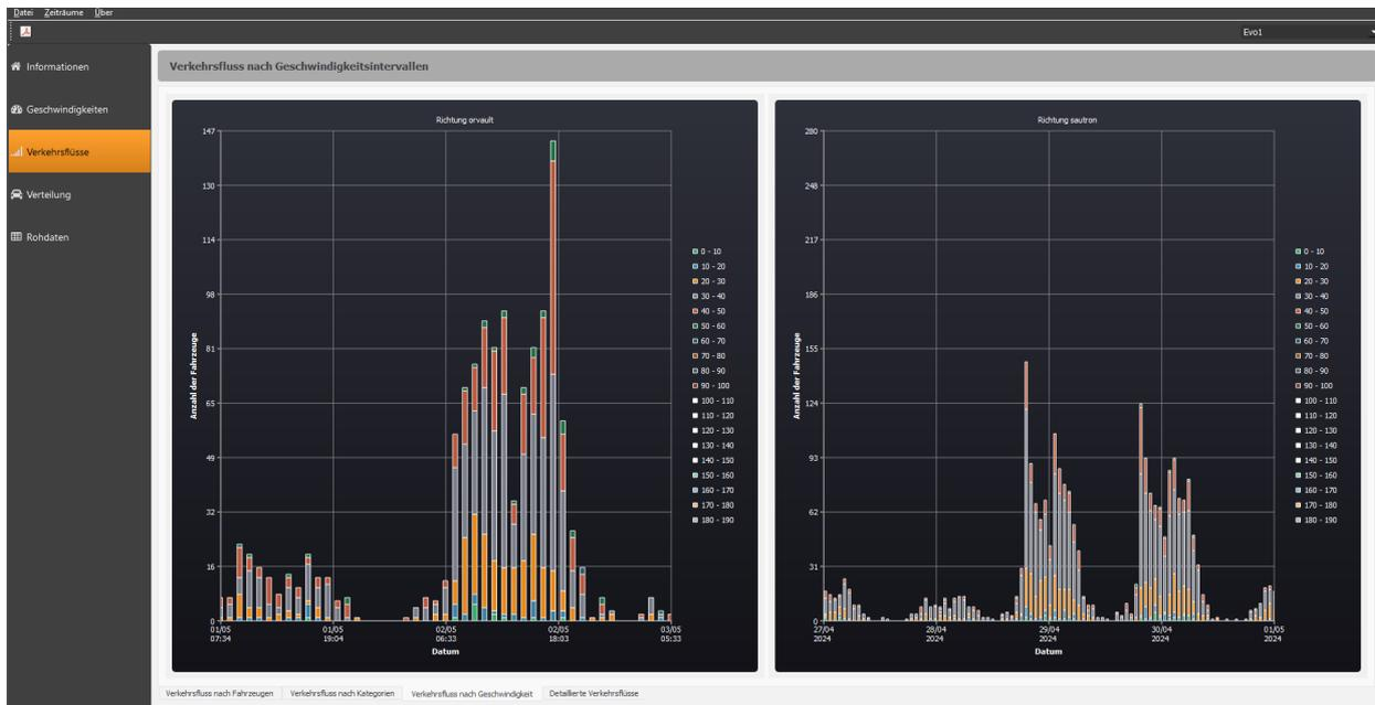
Dieses Diagramm zeigt die Verkehrsflüsse nach Datum an, hier allerdings nach Geschwindigkeitsbereich. Eine Farbe im Diagramm definiert einen Geschwindigkeitsbereich, der in der Legende angegeben ist.
