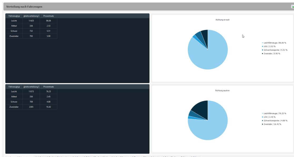
Die Aufschlüsselung nach Fahrzeugen ermöglicht Ihnen eine detaillierte und visuelle Analyse der Anzahl der Fahrzeuge, die während des Messungszeitraums durchgefahren sind, und zwar differenziert nach Kategorien. Aufgeteilt in verschiedene Richtungen werden eine Tabelle und ein Kreisdiagramm präsentiert. Aus der obigen Abbildung geht hervor, dass 783 Zweiräder in Richtung „Ornvault“ unterwegs waren, was 5,90 % des Gesamtverkehrs entspricht.
