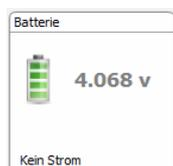
Anzeige des Batteriestands. Bei niedrigem Batteriestand ändert das Symbol seine Farbe. Ein vollständig geladener Akku hat eine Spannung zwischen 3,9 V und 4,1 V.
