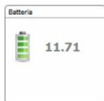
Indicazione del livello di batteria. Se la batteria ha poca carica, l'icona cambierà colore. Una batteria completamente carica ha un valore compreso tra 12,8 V e 13,1 V.
