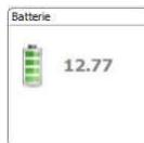
Indication du niveau de batterie. En cas de batterie faible, l'icône change de couleur. Une batterie complètement chargée se situe entre 12,8V et 13,1V
