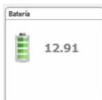
Indicación del nivel de batería. Cuando la batería tiene poca carga, el icono cambia de color. Una batería totalmente cargada se sitúa entre 12,8 V y 13,1 V.
