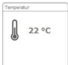
Anzeige der Innentemperatur der GA. (Achtung, die angezeigte Temperatur entspricht der Innentemperatur der GA und nicht der Umgebungstemperatur)
