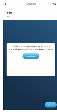
Lors de ce test, un véhicule sera volontairement arrêté au pied du feu afin de valider le bon fonctionnement de l'antenne.
