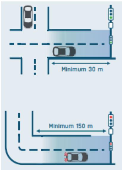
Le conducteur ne doit pas être perturbé par des facteurs extérieurs en approche et en sortie du dispositif. Entre la détection amont et jusqu'à 30 m après le feu, il ne doit pas y avoir :
