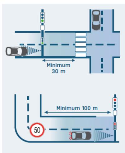
De plus, pour un fonctionnement optimal du feu EVOLIGHT il est important de respecter rigoureusement les points suivants :
