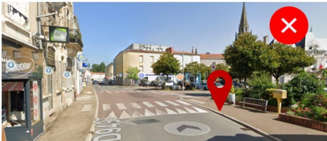
Dans ce cas, l'installation n'est pas conforme, car la distance entre l'EVOLIGHT et le passage piétons serait inférieure à 30 mètres.
