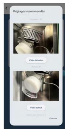
L'application vous indique la position à appliquer sur l'antenne de détection en pied de mât en fonction des informations transmises.
