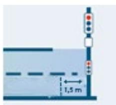
**La matérialisation d'une ligne d'effet au sol n'est pas obligatoire, mais nous recommandons fortement son utilisation à une distance de 1.5 m du feu. En effet, la présence de ce marquage maximise l'impact du feu sur les conducteurs et leur indique la zone de détection du capteur en pied de mât, notamment en cas de non-détection du véhicule par l'antenne longue distance.**
