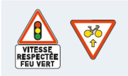
Le pack de signalisation permettant l'annonce du feu EVOLIGHT ne doit pas être installé à une distance de moins de 65 mètres en amont de celui-ci. Nous vous conseillons, pour une meilleure efficacité, une installation comprise entre 100 et 150 mètres
