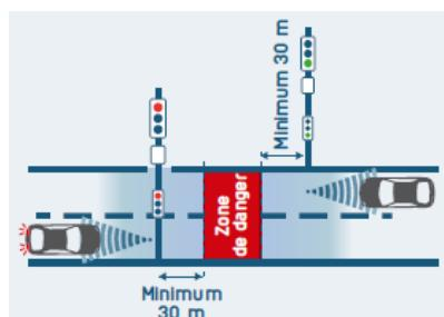
Pour les rues à double sens, simplement un seul des sens de circulation doit être équipé du dispositif afin d'éviter que cela ne soit perçu comme des feux régulant une zone de danger (carrefour, passage piéton, école, ...).
