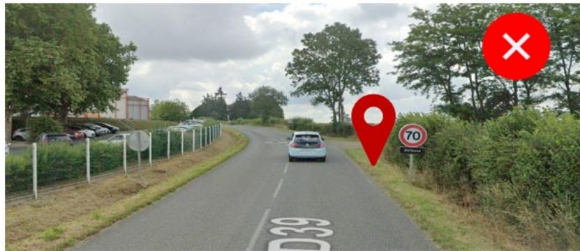
Dans ce cas, l'installation n'est pas conforme, car l'EVOLIGHT ne peut être implanté qu'en agglomération et sur une zone de vitesse n'excédant pas 50 km/h.
