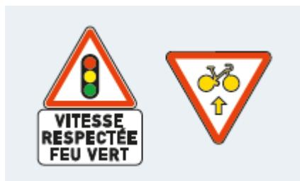
Le pack de signalisation permettant l'annonce du feu EVOLIGHT ne doit pas être installé à une distance de moins de 65 mètres en amont de celui-ci.
