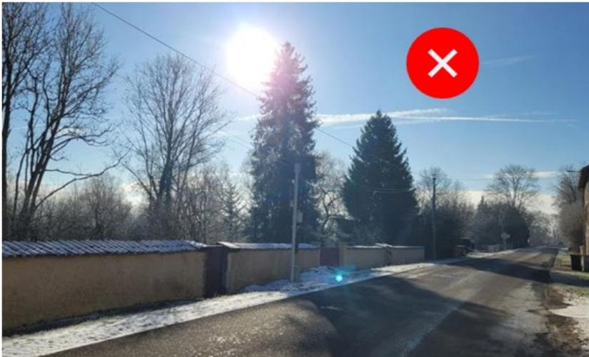
Dans ce cas, l'installation n'est pas conforme. En effet, pour assurer une autonomie en alimentation solaire, le panneau solaire de l'EVOLIGHT doit être positionné de manière à être dégagé en tout temps, sans être affecté par l'ombre, la végétation, les bâtiments, etc.
