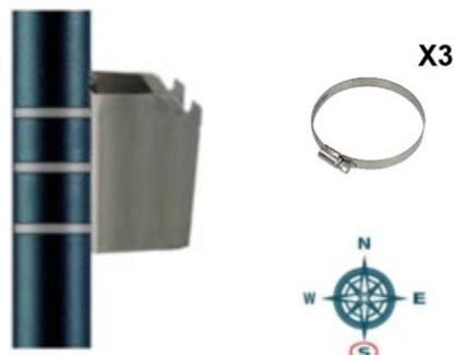
Poser le panneau sur la fixation mât, puis adapter l'orientation et visser-le
