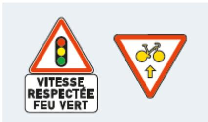
Le pack de signalisation permettant l'annonce du feu EVOLIGHT ne doit pas être installé à une distance de moins de 65 mètres en amont de celui-ci.
